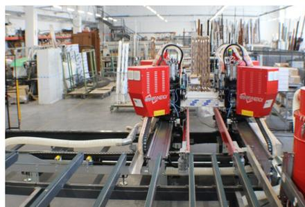
Ulteriore valore è stato assicurato dai banchi di foratura automatizzati per le cerniere, post saldatura, grazie ai quali aumenta la velocità di realizzazione, con una precisione esecutiva ancora maggiore.
